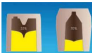
Gambar 1 Pengaruh Variasi bentuk exothermic sleeve pada efisiensi penambah.
